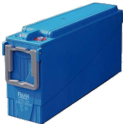
Серия аккумуляторов XL характеризуется отличными показателями цикличности благодаря сочетанию плоской намазной пластины и гелевого электролита, а фронтальное исполнение позволяет размещать батареи с использованием меньшего пространства в 23 дюймовых шкафах, на стеллажах и в телекоммуникационном оборудовании.
