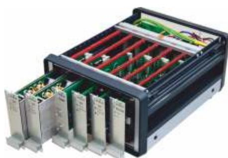
Напряжение питающей сети постоянного тока, при котором обеспечивается безаварийное функционирование, В 18 – 60<sup>1</sup>
