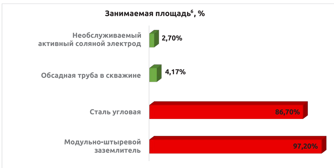
Рис. 10. Соотношение площадей, необходимых для организации заземляющих устройств в многолетнемерзлом грунте
