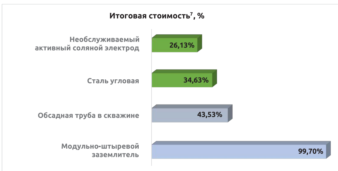
Рис. 11. Соотношение итоговой стоимости организации заземляющих устройств в многолетнемерзлом грунте
