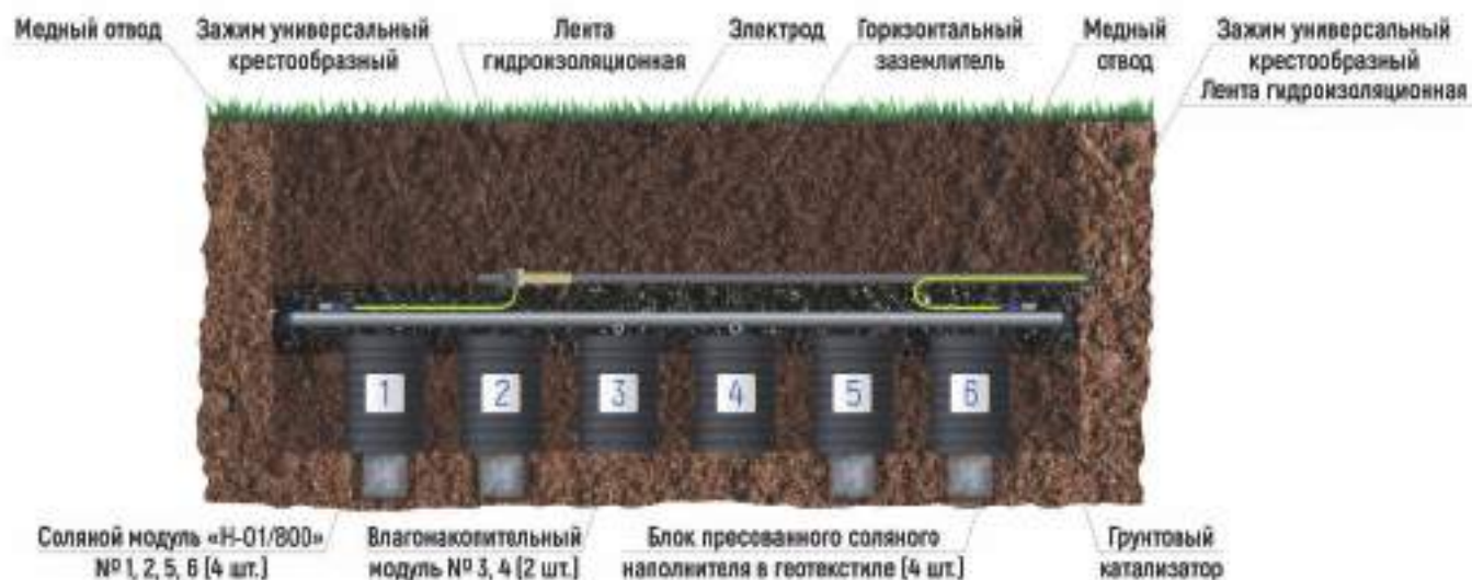
Рис. 7. Необслуживаемый активный соляной электрод «10 Ом»
