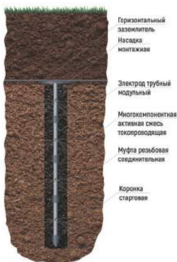
Рис. 10. Объёмный графитовый электрод «АСПИД»
