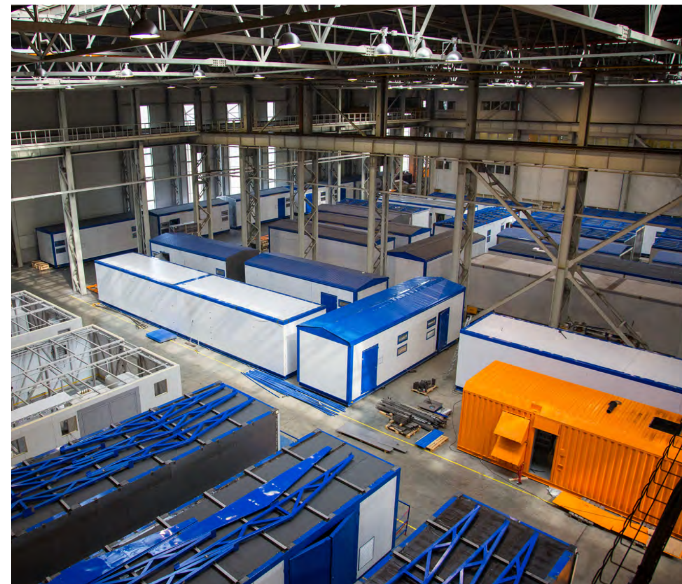
Участок изготовления блочно-модульных конструкций
