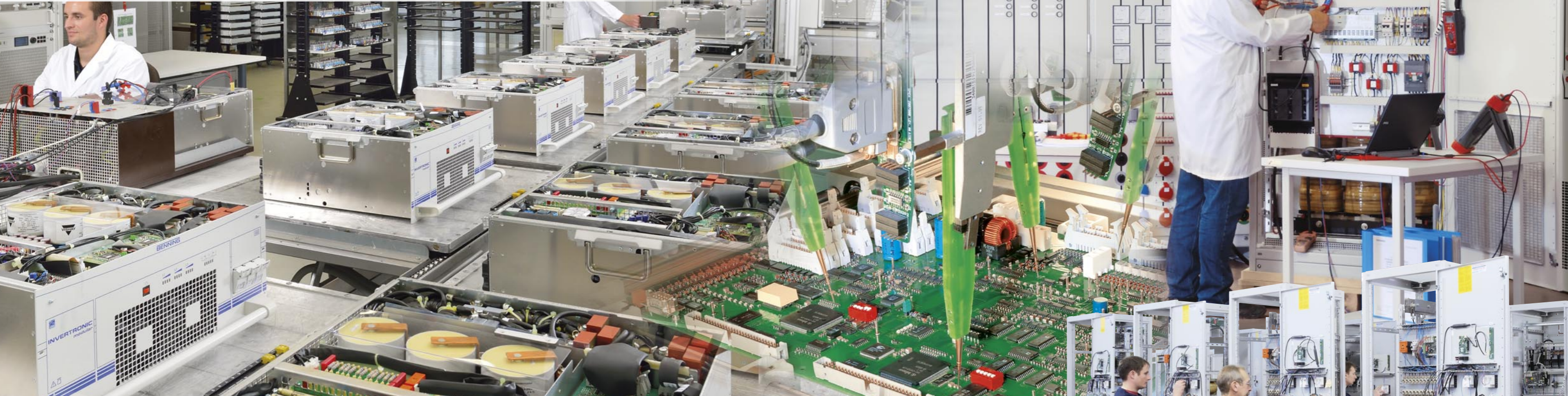
Montage und Prüffeld von Wechselrichtereinschüben Inverter module assembly and test facility
