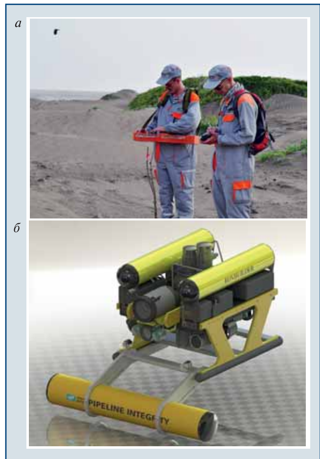
▲ Рис. 2. Процесс подземного сканирования (а) и оборудование для подводного сканирования (технология АКВА-МТМ) (б)
