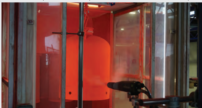
Участок порошковой окраски баллонов и коллекторов
