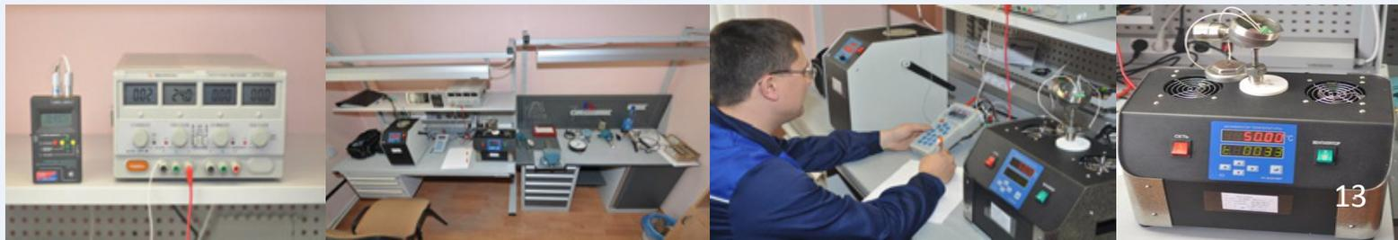
Для калибровки термопреобразователей сопротивления (в том числе с унифицированным токовым выходным сигналом), термоэлектрических преобразователей, показывающих термометров применяются:
